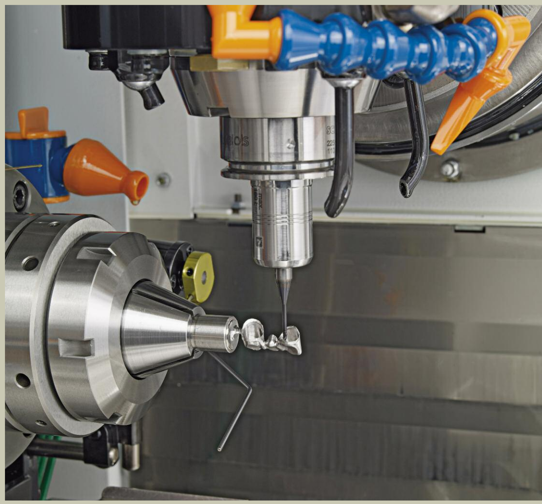
Bild 4. Für schwierige Bearbeitung bestens gerüstet: Mikrobohrer und -fräser aus unbeschichtetem und beschichtetem Vollhartmetall mit speziellen Geometrien an Spitzen, Schneiden und Fasen bearbeiten auch harte und zähe Werkstoffe produktiv und wirtschaftlich
