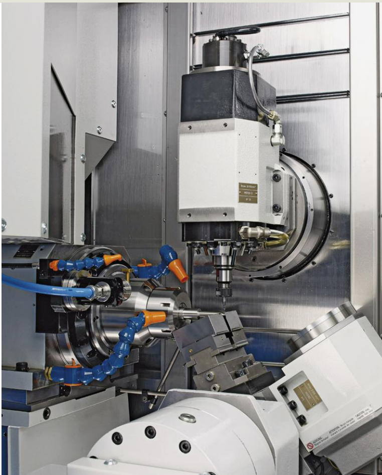
Bild 1. Drehen, Fräsen, Bohren: Mit ihren fünf bis acht CNC-Achsen realisieren Dreh-Fräszentren von Willemin-Macodel eine Komplettbearbeitung für Mikrobauteile
